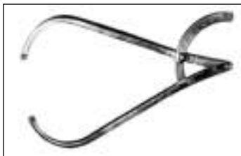
Рис. 2. Инструмент для измерения диаметров – толстотный циркуль
