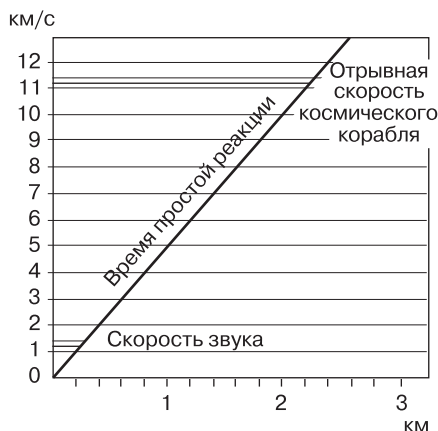
Рис. 21. Дистанции, проходимые за время реакции при различных скоростях (по Штругхолду, 1951, переработано).
